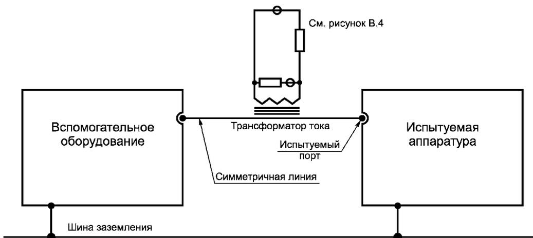
б) Испытательная схема для варианта 2
