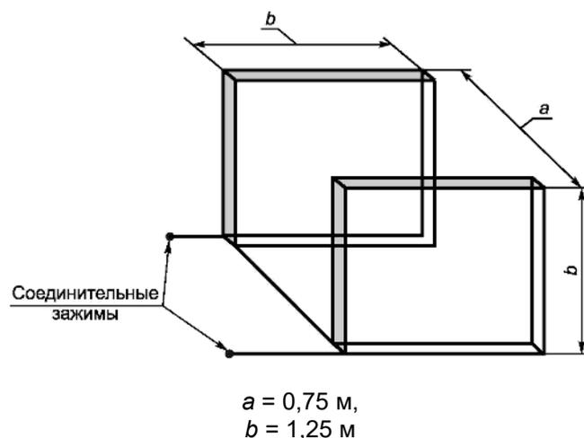
Максимальный диаметр сферы, заключающей в себя испытываемую аппаратуру, составляет 0,7 м при неоднородности поля 5%
