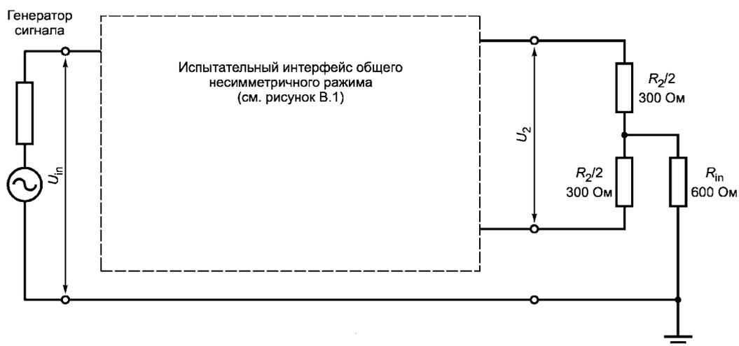
Нижний вывод генератора сигналов должен быть незаземленным
